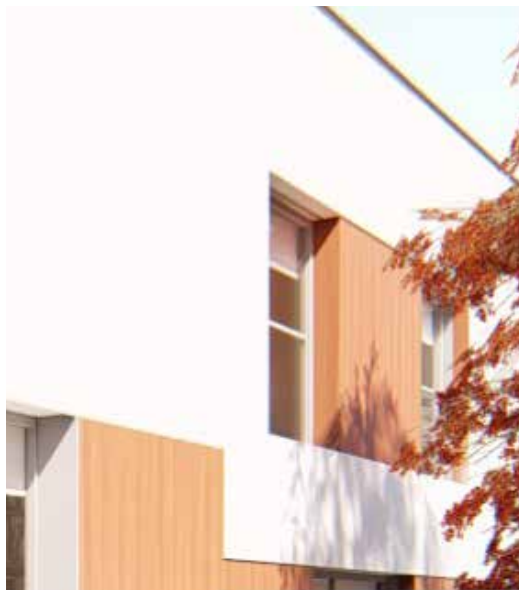
Enfoscado monocapa color blanco Planchas de madera Prodema o similar
